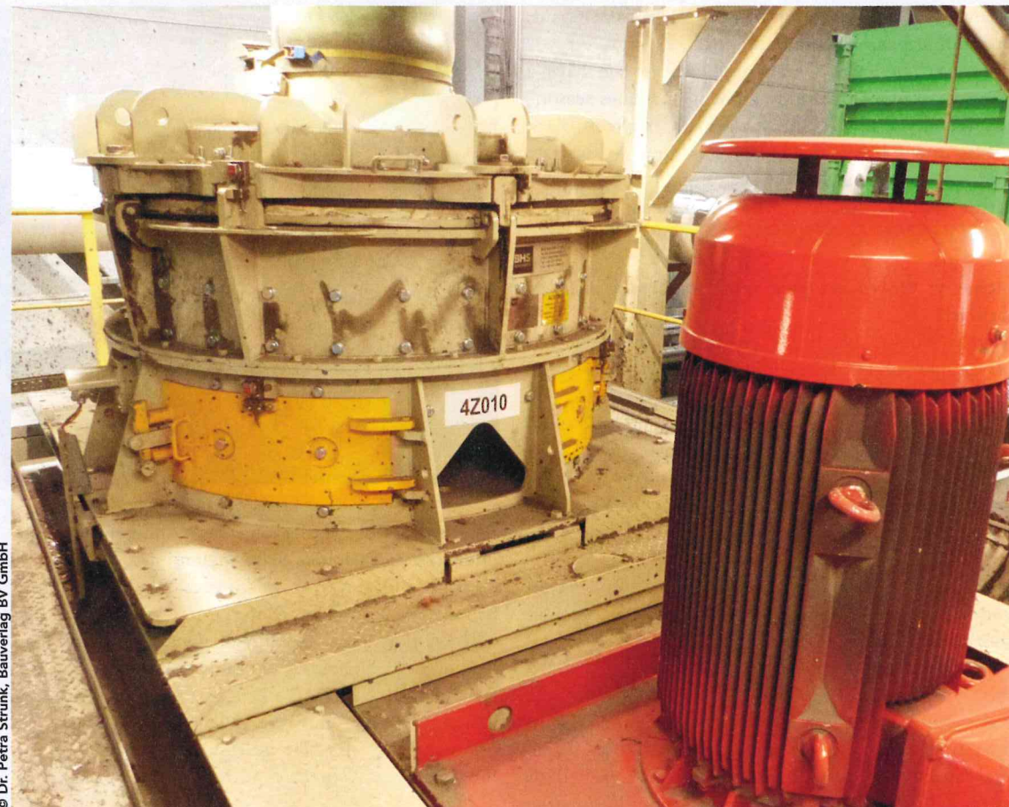
BHS RPMV rotor impact mill in operation BHS Rotorprallmühle RPMV im Einsatz
