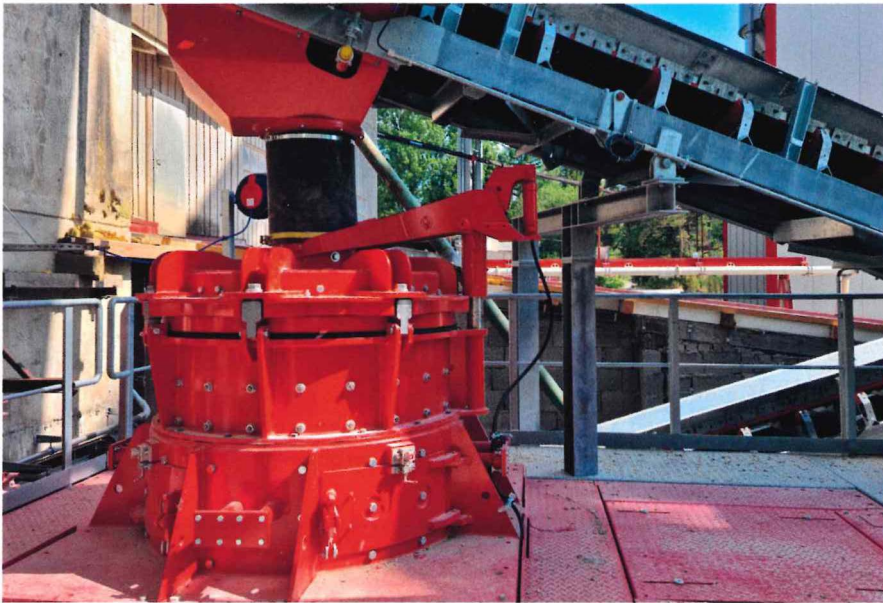
FÜR DIE SANDHERSTELLUNG aus Überschusskörnungen hat die Firma Dachser 2019 eine BHS-Rotorprallmühle vom Typ RPM 1513 installiert. Fotos: BHS-Sonthofen
