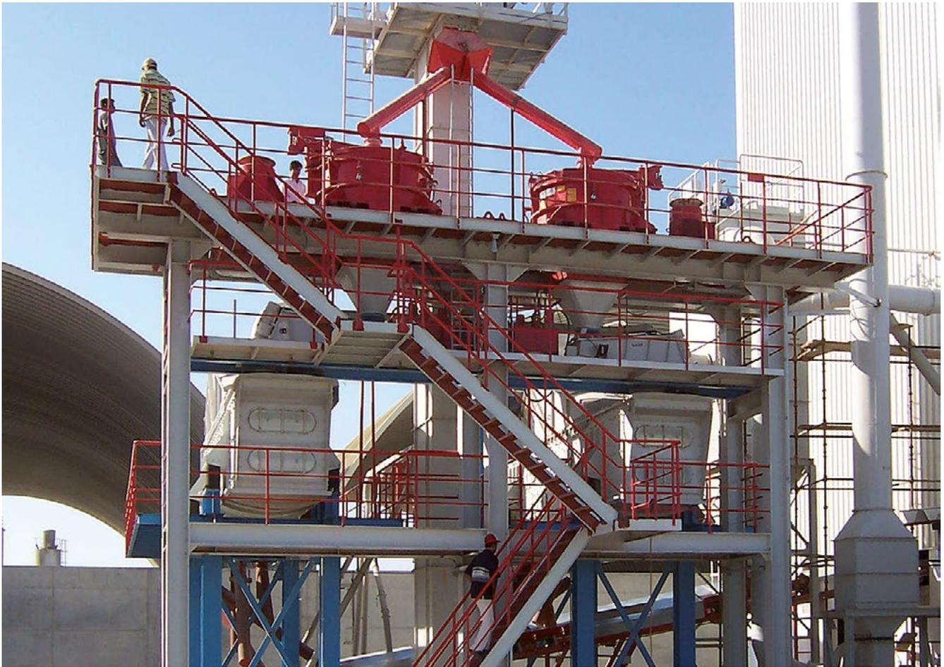
Utilisation de deux impacteurs à rotor de type RPM 1513 dans une installation de mortier sec aux Émirats Arabes Unis (EAU)
