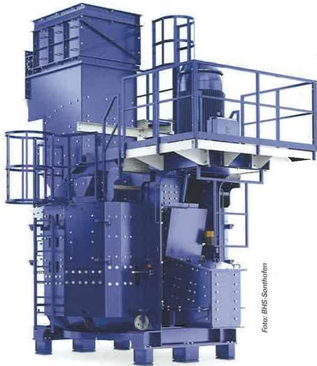
Der Rohrschredder aus Bayern (oben), mit dessen Hilfe etwa aus Elektromotoren (links) Kupferspäne (rechts) gewonnen werden. Foto: BHS-Sonthofen
