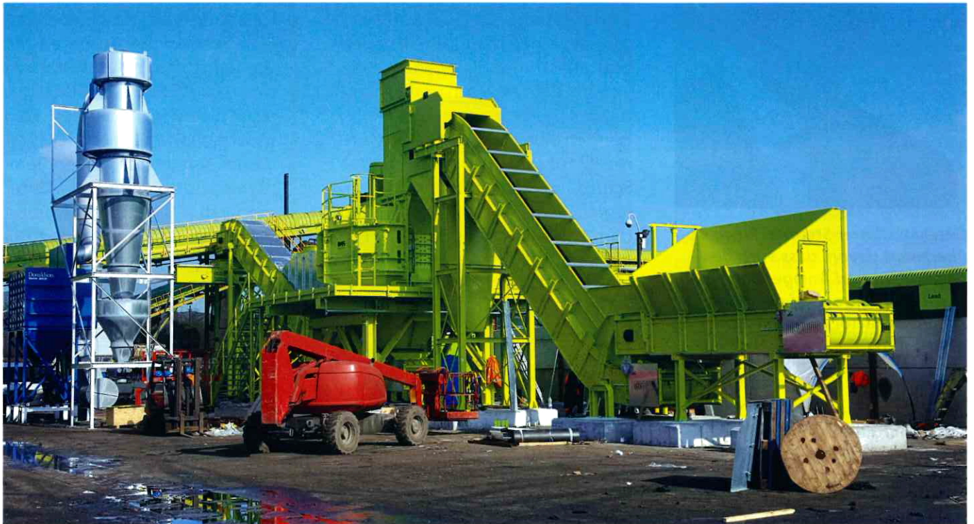
Hier noch im Aufbau zu sehen: Die Recyclinganlage im Vereinigten Königreich für Automotive Shredder Residue (ASR) sowie Elektro- und Elektronikschrott. Sie wurde von BHS-Sonthofen konzipiert und implementiert (©CMüller).
