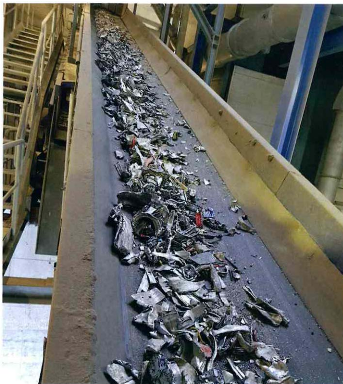
Die Profile verlassen den Rotorshredder – nicht nur zerkleinert, sondern auch aufgeschlossen / The profile rails leaving the Rotorshredder – not only shredded, but broken down too
