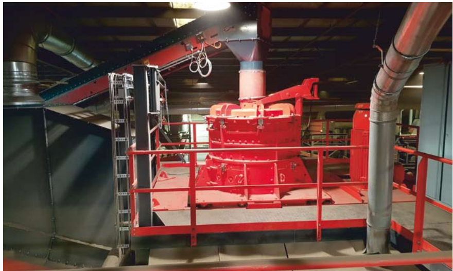
Die Rotorprallmühle (Typ RPMX) von BHS kommt mit stark abrasiven Materialien gut zurecht
