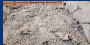
Incinerator bottom ash (IBA)
