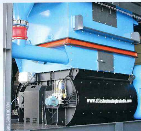
Für die neuen Asphaltmischanlagen mit einer Produktionskapazität von 260 t/h überarbeitete BHS-Sonthofen den Doppelwellen-Chargenmischer vom Typ DKX 2.00 hinsichtlich der spezifischen Einsatzbedingungen beim Asphaltmischen.
